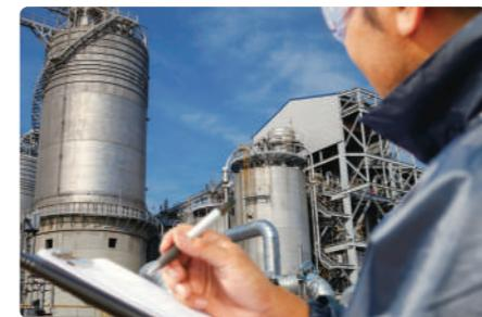
化学プラントの塔槽類・配管等の外面腐食点検、肉厚測定等を行い、設備の劣化を診断します。また、スチームトラップの蒸気漏れ診断による蒸気ロス改善で、省エネと CO<sub>2</sub>排出量を低減します。これら OSI（運転中検査）で、工場の安全・安定操業を支えています。
